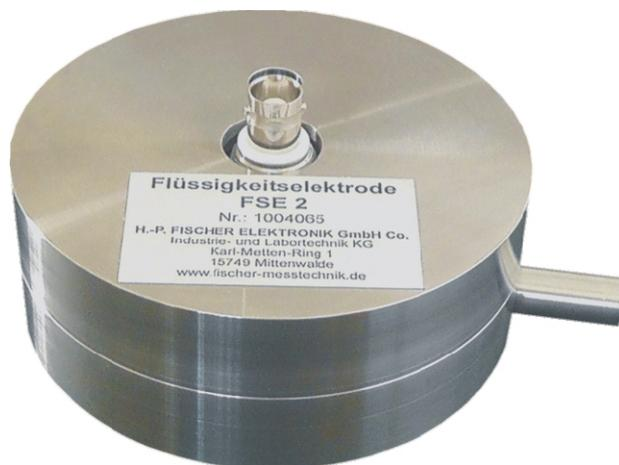
Die Flüssigkeitselektrode FSE 2 eignet sich für die Messung des spezifischen Widerstandes isolierender Flüssigkeiten nach GOST 6581-75. Die Elektrode entspricht dem in dieser Norm dargestellten Aufbau.
